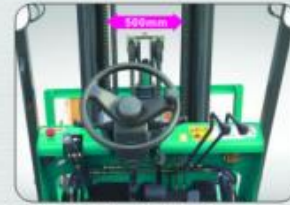
宽视野门架，助力转向 偏左方向盘设计加大前方视野范围
